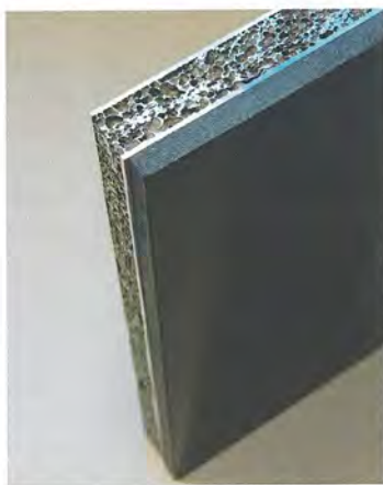
Aufbau metalfoam Fassadenelement für Beschuss- und Explosionstest
